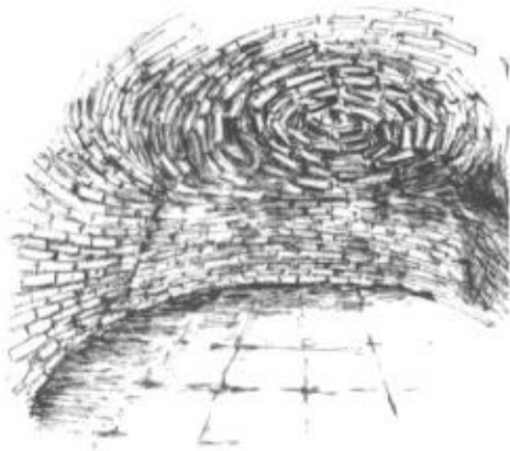
La voûte du four et la sole en briques et carreaux de terre réfractaire.
